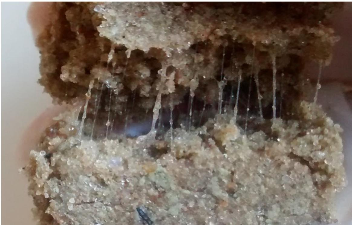
Fig. 3.29: Mezcla de arena-arcilla-APAM donde se puede apreciar el hidrogel de APAM.
