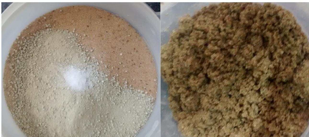
Fig. 3.27: Mezcla de arena-arcilla-APAM previo al mezclado en seco y posterior al mezclado y humedecimiento.
