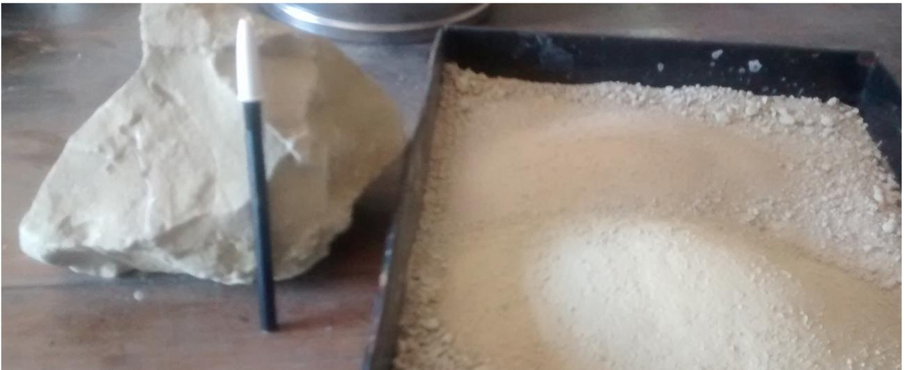
Fig. 3.24: Arcilla en su estado natural en campo y luego de su molienda y tamizado.
