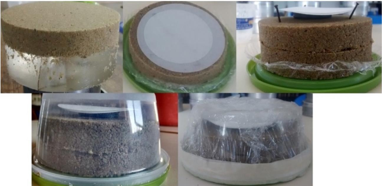
Fig. 3.39: Armado del ensayo de succión.
