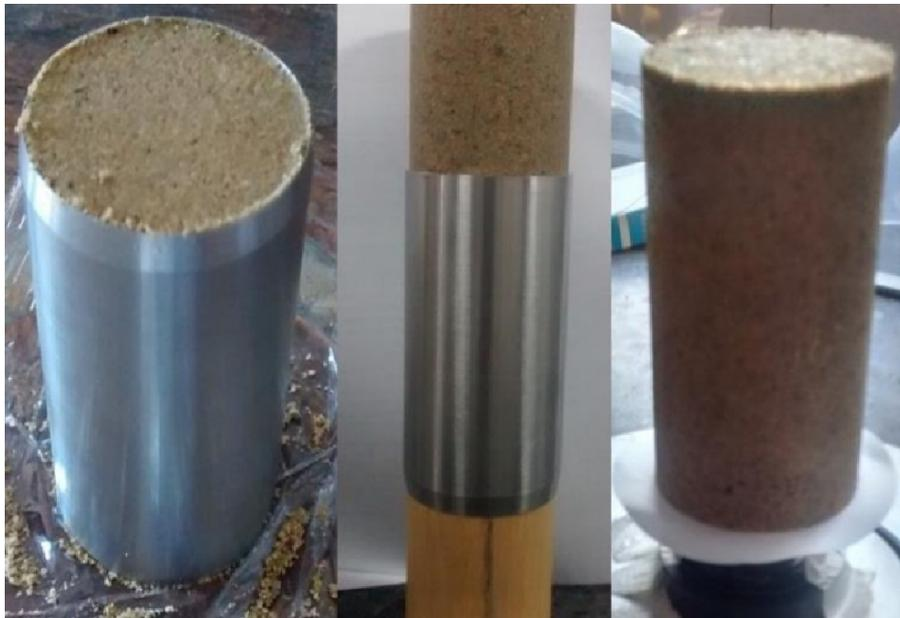
Fig. 3.35: Armado de muestras.
