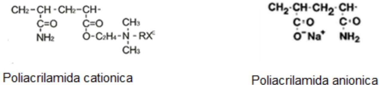
Fig. 2.18: Estructura química de la poliacrilamida en sus versiones aniónica y catiónica.
