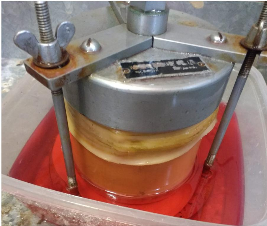
Fig. 7.79: Fallido intento de ensayo de conductividad hidráulica con kerosene.
