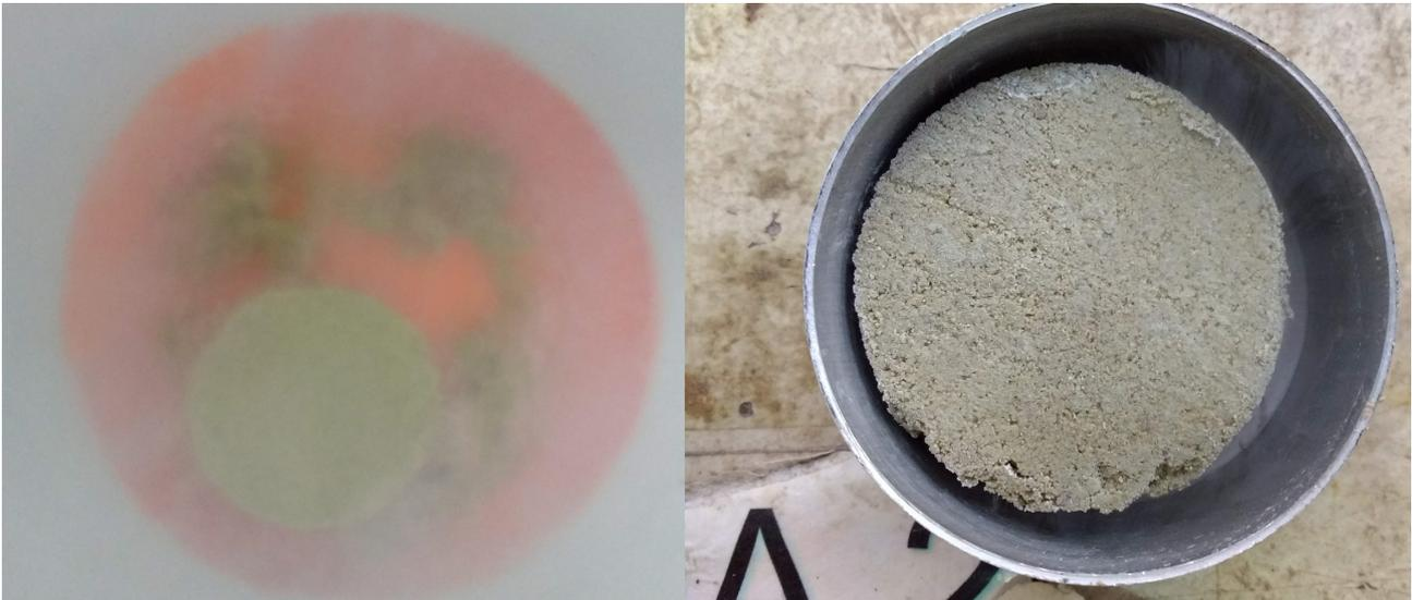
Fig. 3.32: Muestra de suelo durante y posterior a la inundación con nitrógeno líquido.
