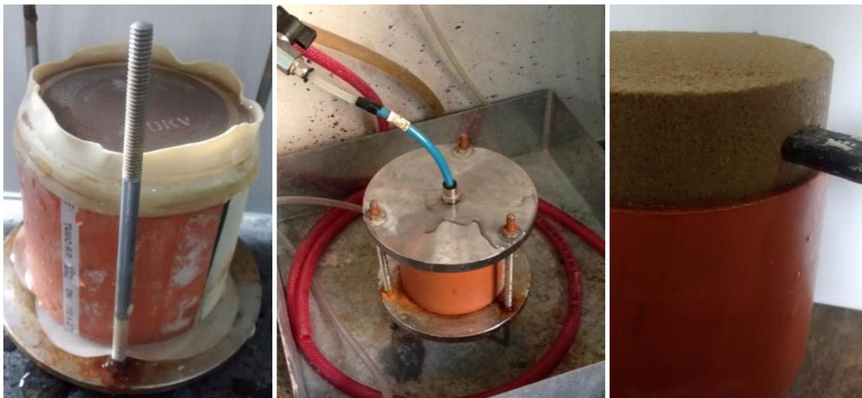
Fig. 3.41: Columnas previo, durante y posterior a la realización del ensayo.
