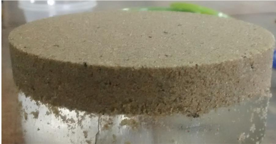
Fig. 3.28: Mezcla de arena-arcilla-APAM compactada.
