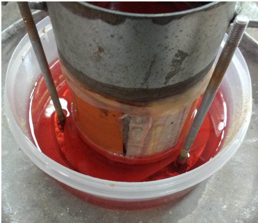
Fig. 7.80: Fallido intento de ensayo de conductividad hidráulica con kerosene.
