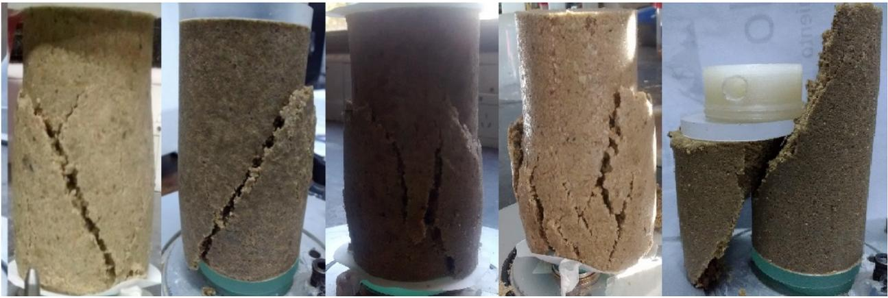
Fig. 3.36: Muestras posterior a la falla del material.
