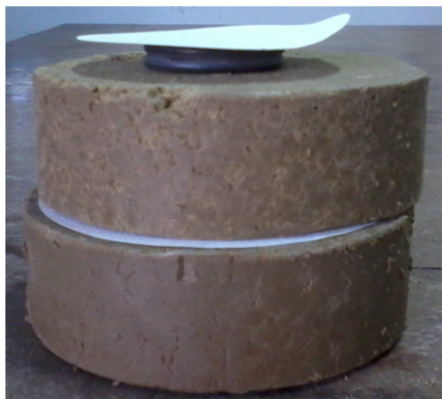
Figura 3.1.30: Armado de ensayo de succión mediante papeles filtro.
