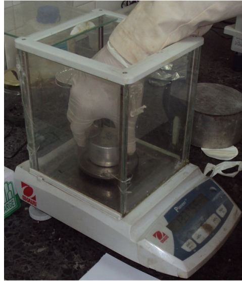
Figura 3.1.32: Balanza electrónica de alta precisión. (0,1 mg)
