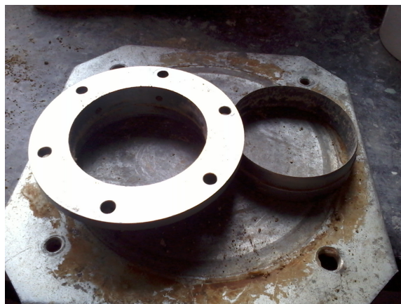
Figura 3.1.14: Molde utilizado para el ensayo de presión de hinchamiento
