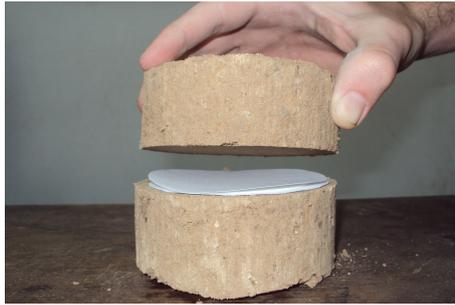
(b) Introducción de papeles de filtro para medición de la succión mátrica.
