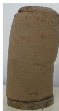
(b) Muestra saturada ensayada en triaxial CIUC.
