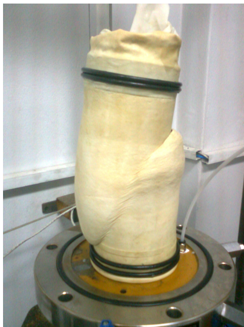
Figura 6.1: Ensayo de compresión triaxial para una arena densa. Laboratorio de Mecánica de Suelos (LAME FiUBA).
