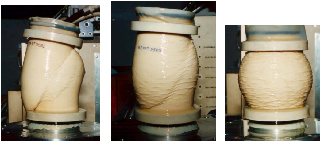
(a) Ensayos de compresión triaxial sobre la arena Hostun RF cargada hasta la falla.
