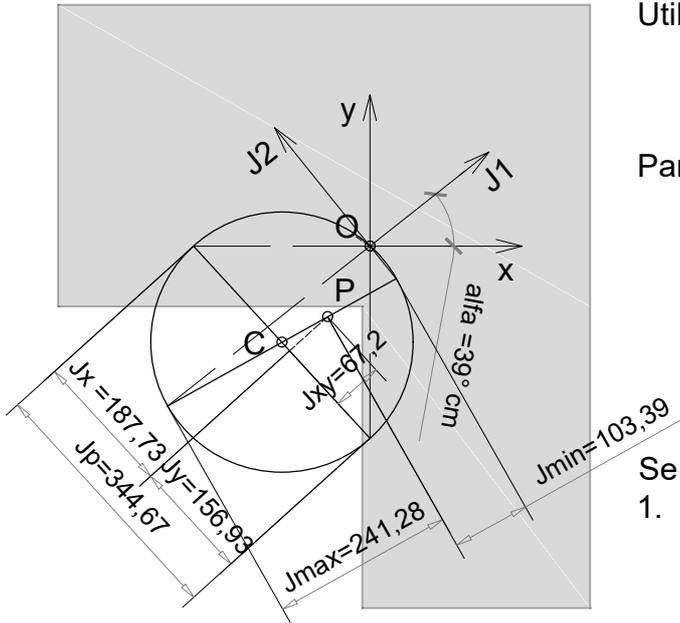
Utilizaremos la circunferencia de Mohr para conocer el valor y la orientación de los ejes Principales de Inercia de una figura (que son independientes del sistema de referencia).
