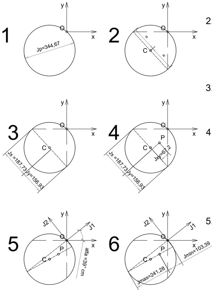
1. Trazar una circunferencia de diámetro igual al Momento de Inercia polar  $J_p = J_x + J_y$ , en una escala cualquiera y con una orientación cualquiera, pero de modo que pase por el origen de coordenadas O.
