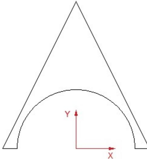
Se descompone la figura compuesta en dos figuras simples; un triángulo y un semicírculo. Utilizando la tabla de propiedades geométricas se obtienen las áreas y las coordenadas de los baricentros.
