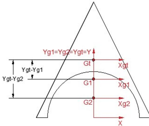
Se calculan utilizando el teorema de Steiner los valores de los momentos de inercia de la figura total respecto de los ejes Xgt, Ygt
