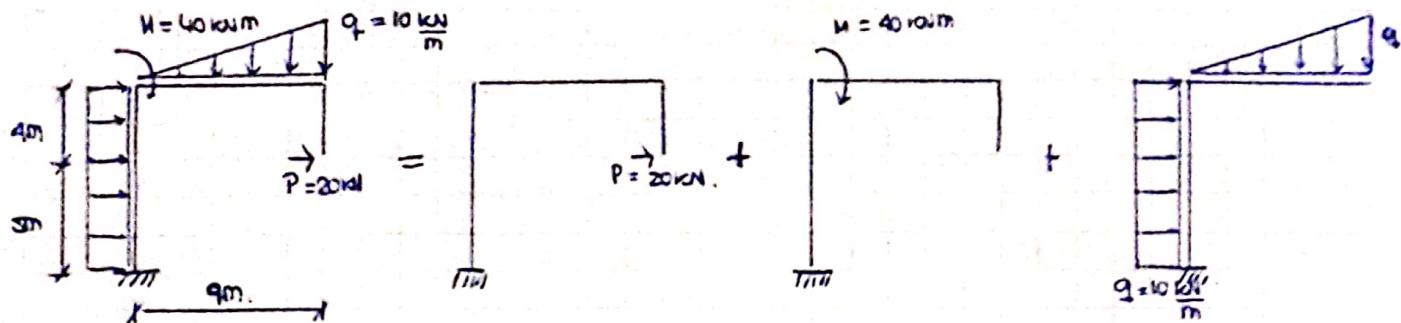
En este caso separe el sistema en tres sistemas; dependiendo del tipo de carga externa que tiene aplicada.
