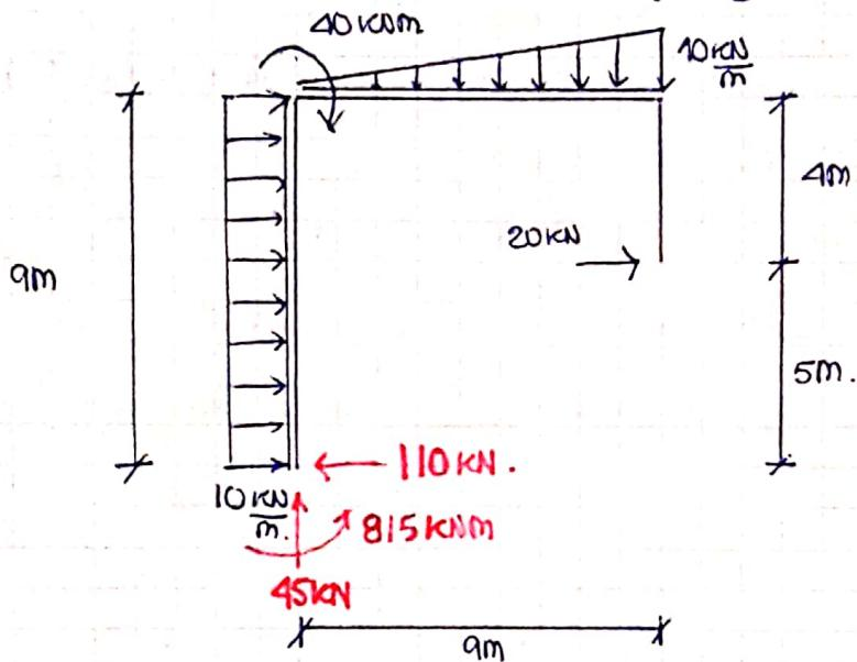
Resolucion 2: Aplico el Principio de superposición de efectos
