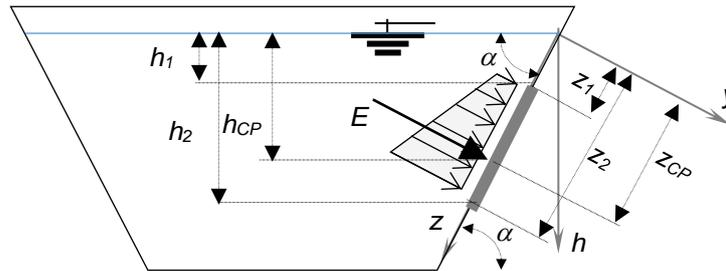
Figura 25. Compuerta inclinada
