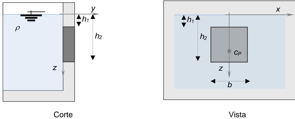
Figura 14. Compuerta rectangular sobre pared plana vertical
