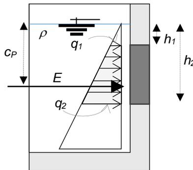
Figura 15. Diagrama de cargas, empuje  $E$  y profundidad del empuje  $c_p$
