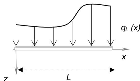
Figura 4. Carga lineal equivalente
