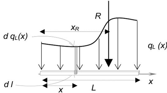
Figura 5. Resultante de carga lineal
