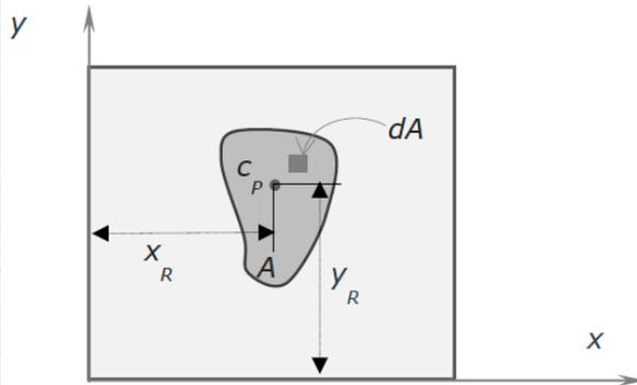
Dada una superficie plana  $A$  sobre la cual actúa una carga distribuida  $q$  perpendicular al plano de la superficie. La carga está compuesta por una distribución de fuerzas paralelas, puede ser representada mediante una función continua y derivable  $q(x,y)$ .
