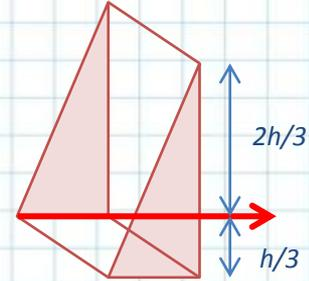
Podemos constatar rápidamente que el valor del empuje coincide con el área del diagrama de cargas, que en este caso resulta triangular (base =  $2Rh\gamma y$  y altura =  $h$ ).
