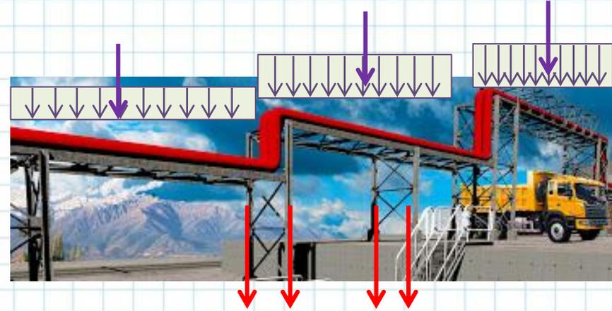
Para la estática global de la estructura al utilizar la carga distribuida o la resultante se obtienen los mismos resultados. Los efectos sobre el cuerpo difieren.
