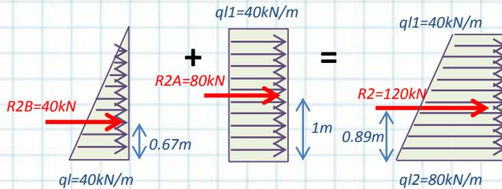
$$Z_{R2} = (40 \text{ kN} \cdot 0,67 \text{ m} + 80 \text{ kN} \cdot 1 \text{ m}) / 120 \text{ kN} = 0,89 \text{ m}$$
