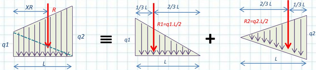
Otro razonamiento: usar las figuras simples, dos triángulos y aplicar teorema de Varignon:
