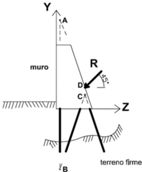
El muro de contención de la figura está apoyado en el terreno y está sostenido por tres pilotes con dirección A-B, B-C y A-C
