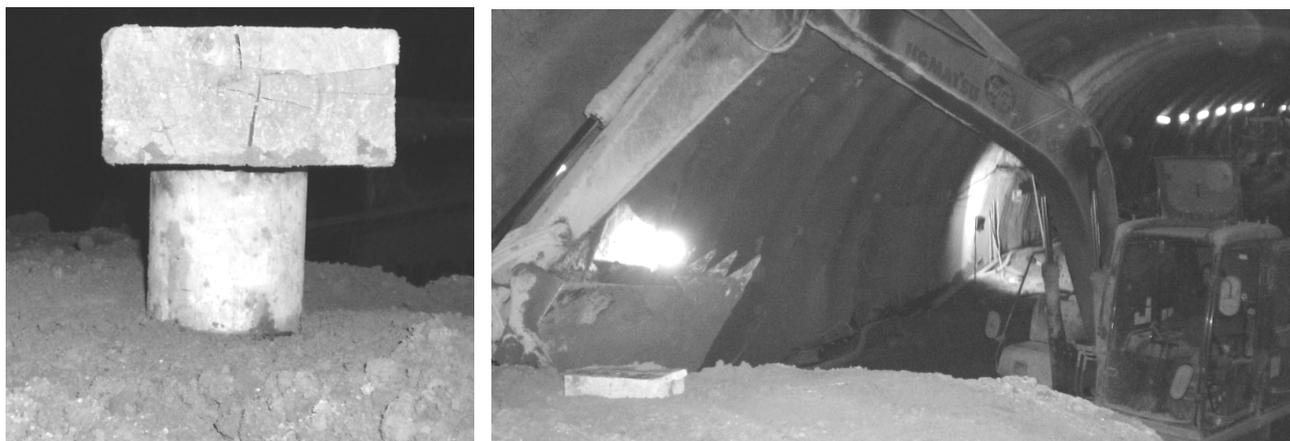
Figura 1: Extracción de muestras inalteradas mediante hinca estática de un tubo de acero.
