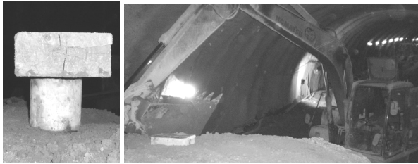
Figura 1: Procedimiento de extracción de muestras inalteradas mediante hinca estática de tubo.
