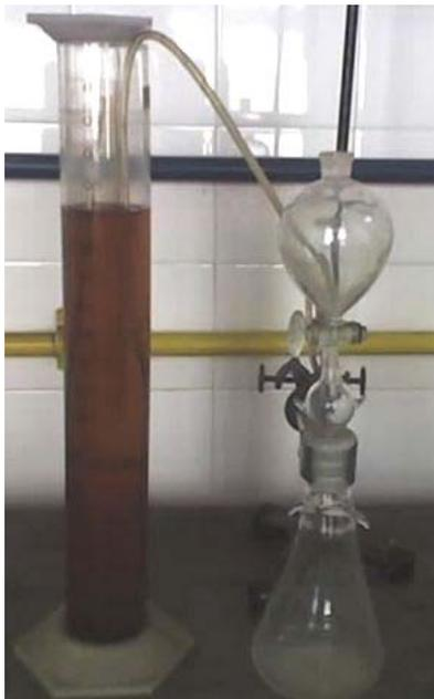
Figura 4. Dispositivo para la medición de  $CaCO_3$ .
