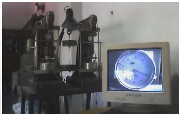
Figura 3. Detalle del sistema de adquisición de datos.
