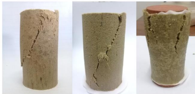
Figura 3-2 – Probetas en falla
