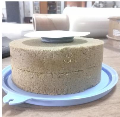
Figura 3-1 – Muestra en preparación para ensayo de curva de retención
