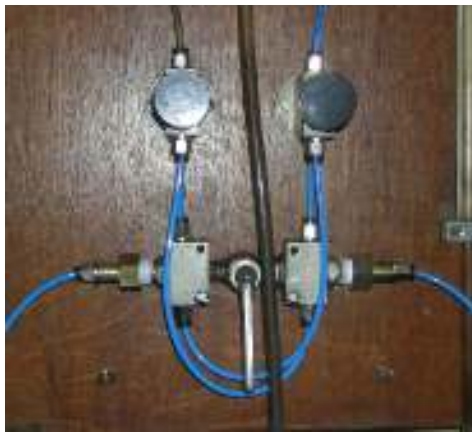
Fig. 9. Croquis y foto de llaves de comando del tablero. Vista frontal.
