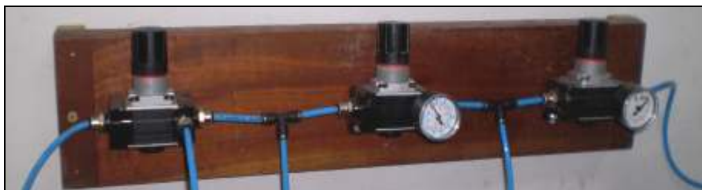
Fig. 5. Vista general del banco de reguladores
