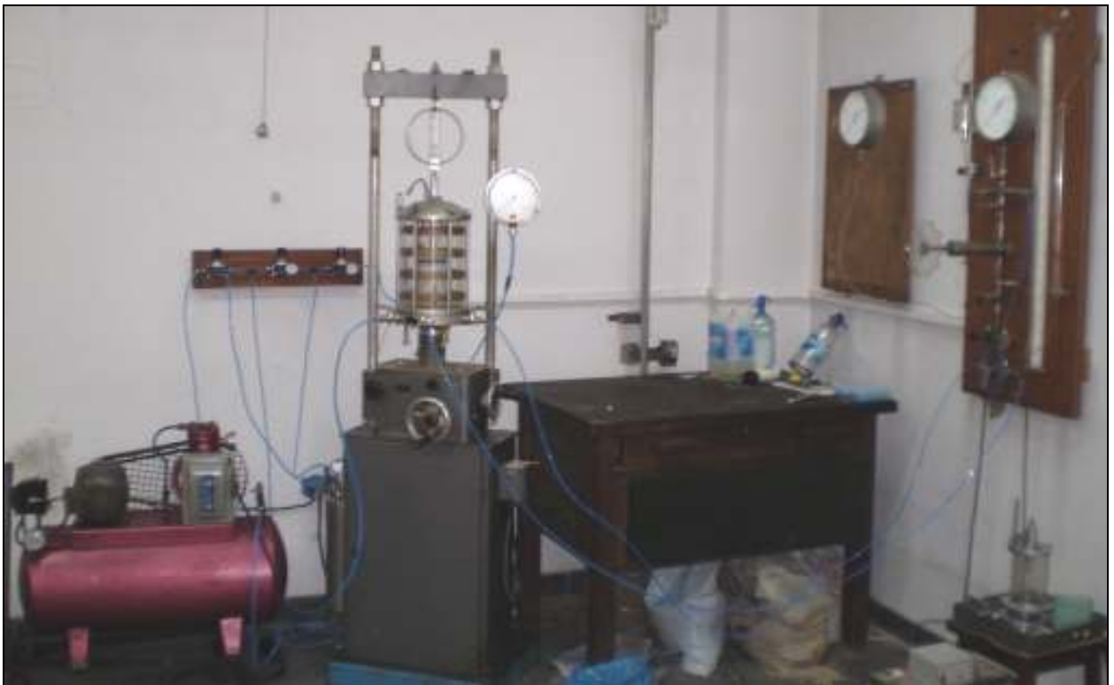
Fig. 1. Vista general de la cámara triaxial con accesorios.
