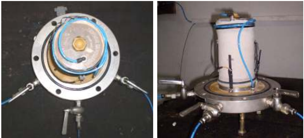
Fig. 12. Vista superior y lateral de la base de la cámara triaxial con acoples rápidos instalados en sus válvulas.
