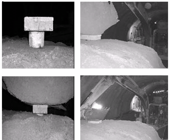
Figura 34: Procedimiento de extracción de muestras inalteradas mediante hinca estática de un tubo.
