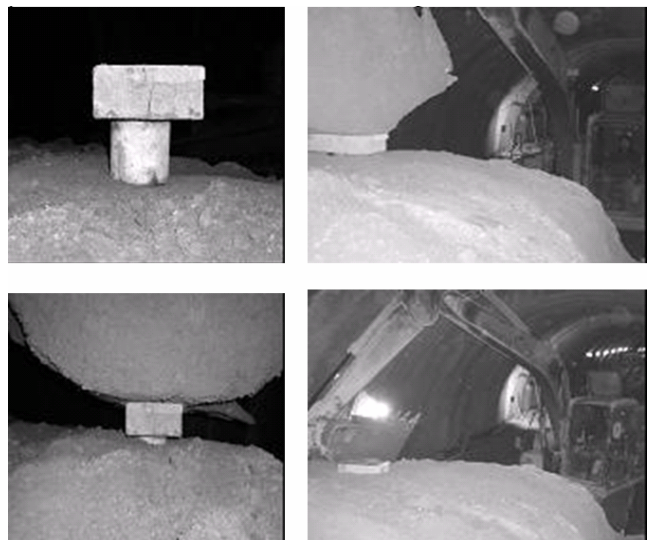
Figura 3. Procedimiento de extracción de muestras inalteradas mediante hinca estática de un tubo.
