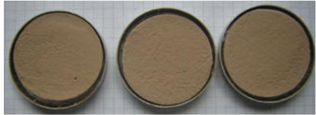
Figura V.2 Muestras de suelo al finalizar el ensayo de Límite de Contracción.
