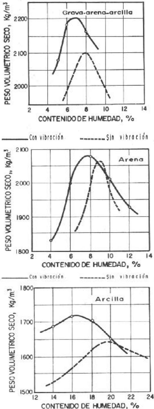
Figura II.9. Peso unitario seco luego de la compactación con y sin vibración (Rico y Del Castillo 1974).
