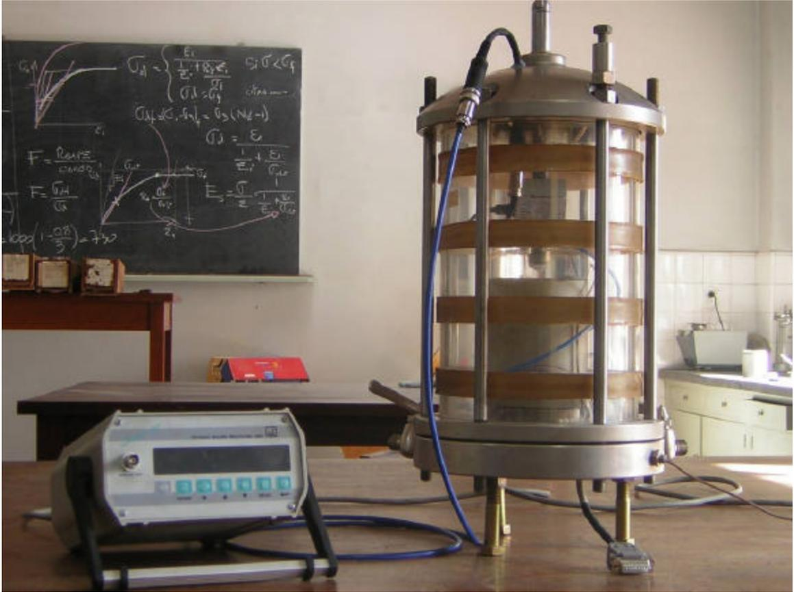
Imagen 3, cámara triaxial con celda de carga y conexiones de salida.
