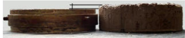
Figura IV.6. Muestra luego del ensayo de hinchamiento.
