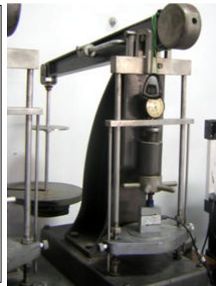
Imagen 10. Calibración de la celda de carga
