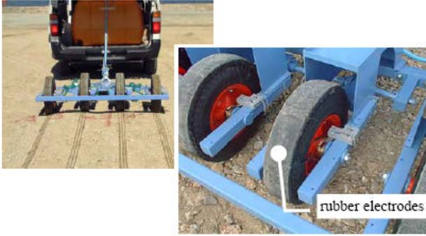
Figura. II.16. Equipo de control mediante electrodos (Nobumasa et al 2003).
