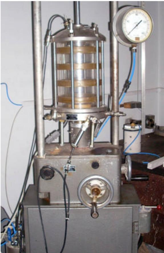
Figura IV.1. Máquina triaxial colocada en la prensa.
