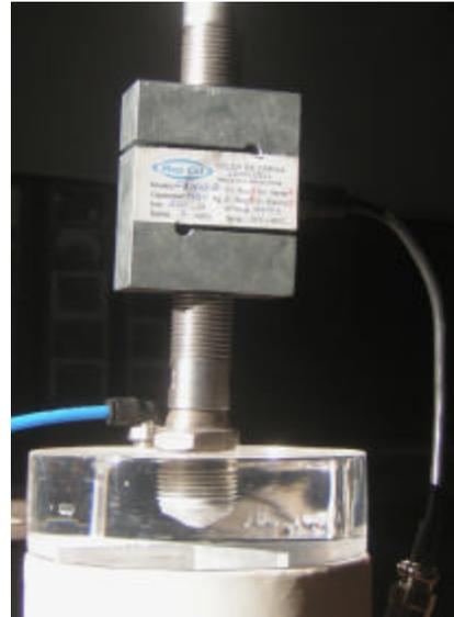
Figura IV.13. Celda de carga con elementos de acople.
