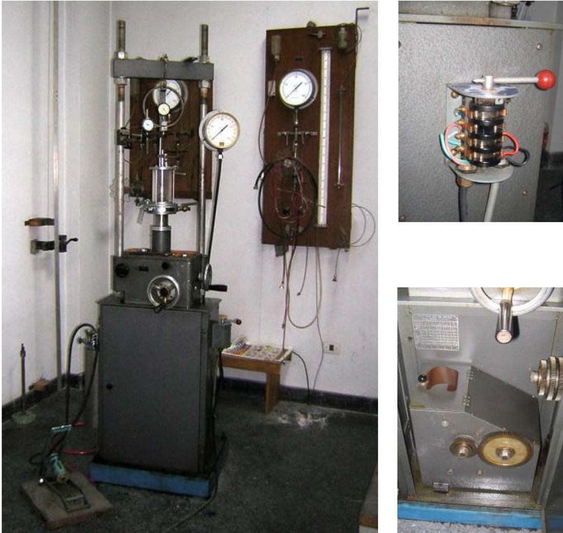
Imagen 1, prensa/pórtico con cámara triaxial chica y detalles.
