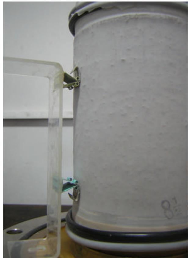
Figura V.9. Colocación de las fijaciones de los LDTs sobre una muestra de suelo.
