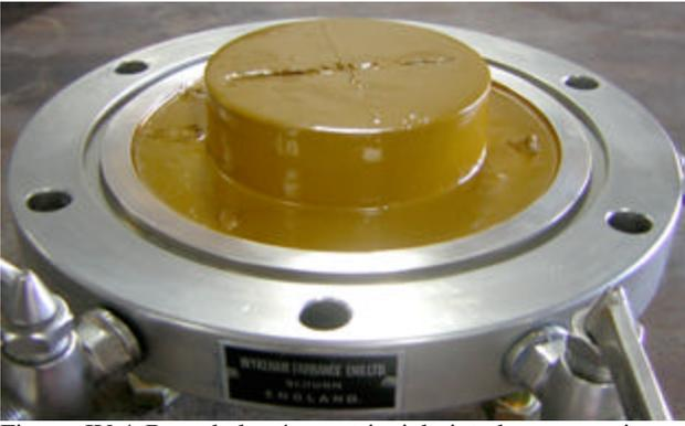
Figura IV.4. Base de la cámara triaxial pintada con epoxi.
