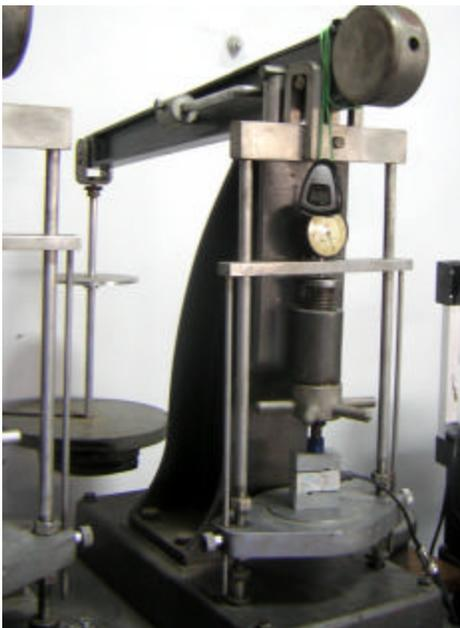
Figura IV.19. Calibración celda de carga en banco edométrico.
