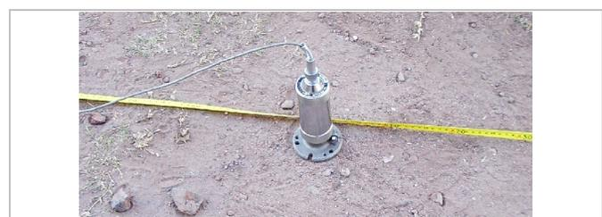
Figura 87: Velocímetro de 30 Hz
