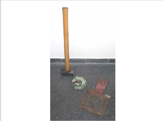
Figura 88: Maza de 8 Kg; pesa de 10 Kg; placa metálica
