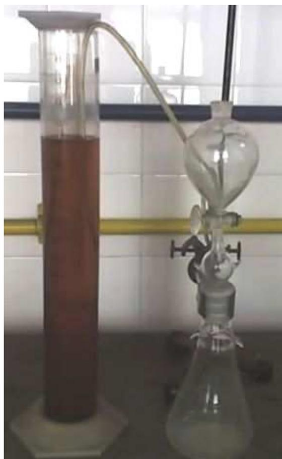
Figura 1. Dispositivo para la medición de  $CaCO_3$ .
