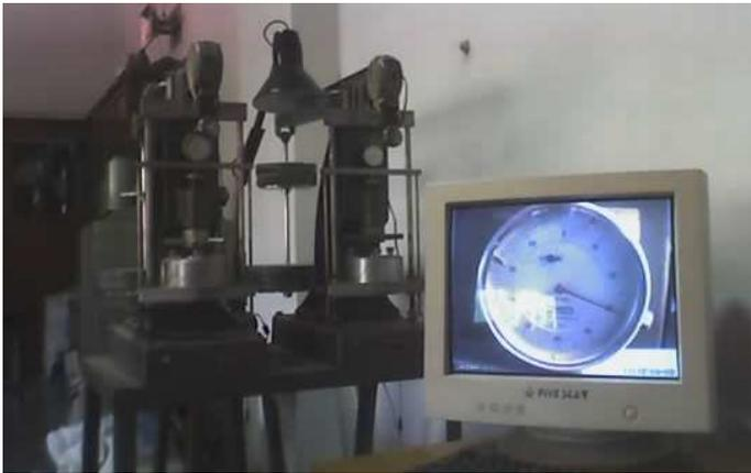
Figura 3. Detalle del sistema de adquisición de datos del banco edométrico.
