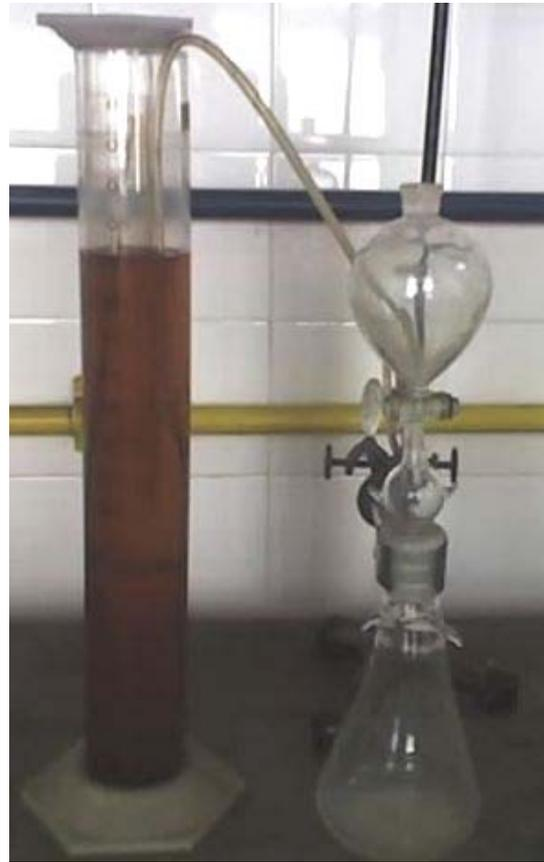
Figura 30. Dispositivo para la medición de  $CaCO_3$ .
