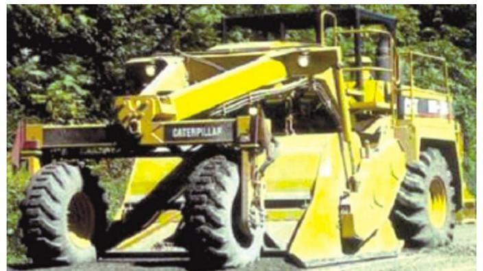
Figura 17: Equipo escarificador-reciclador [11].
