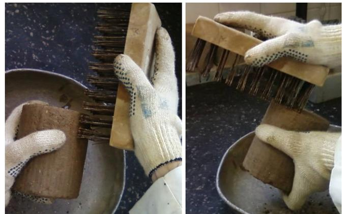
Figura 35: Cepillado de probetas en ensayos de durabilidad.
