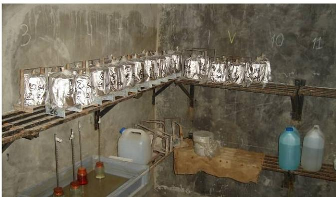
Figura 32: Curado de las probetas en cámara húmeda.
