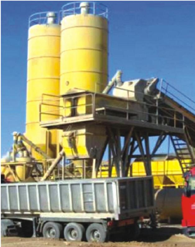
Figura 25: Planta de fabricación de suelo-cemento [11].
