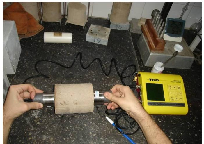
Figura 40: Medición de velocidad de propagación de onda.
