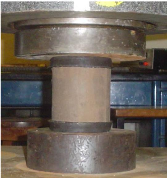
Figura 36: Ubicación de la probeta en la máquina.
