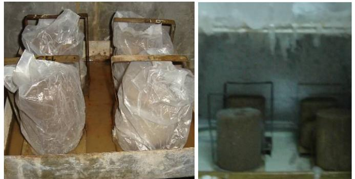
Figura 34: Ensayo de congelamiento y deshielo.
