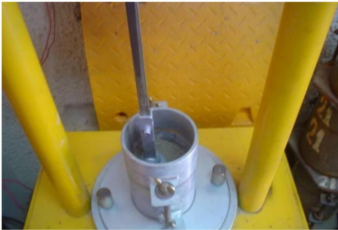
Figura 31: Equipo compactador automático Proctor.
