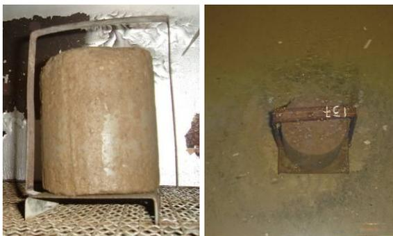
Figura 33: Ensayo de humedecimiento y secado.
