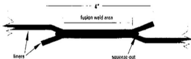
Figura 53: Soldadura por fusión sin incorporación de material (Reddy y Butul 1999).
