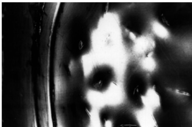
Figura 52: Comportamiento de una geomembrana con escasa protección (Narejo 1995).
