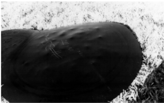
Figura 51: Comportamiento de una geomembrana con escasa protección (Narejo 1995).
