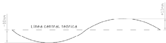
Figura 38 - Tolerancia en alineación horizontal para operación de grúa P148L.
