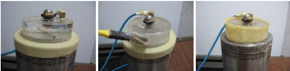
Figura 2.4: Colocación y envaselinado de cabezal superior.
