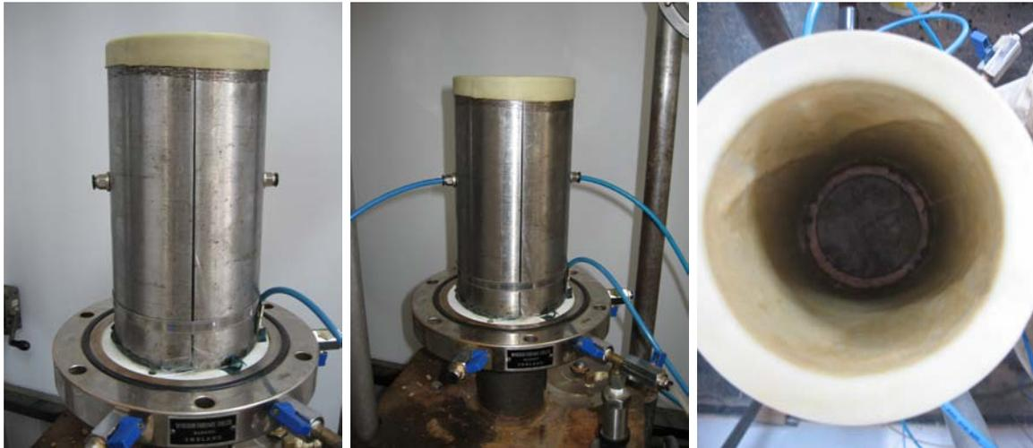
Figura 1.4: Fijación y aplicación de vacío entre la membrana y el molde.
