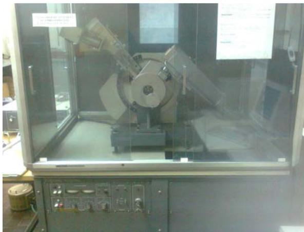
Figura 4.5: Goniómetro vertical  $\theta - \theta$  Rigaku.
