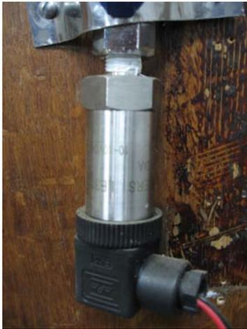
Figura 3.5: Transductor absoluto de presión.
