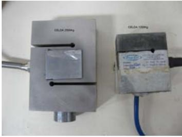
Figura 3.4: Celdas de carga utilizadas.
