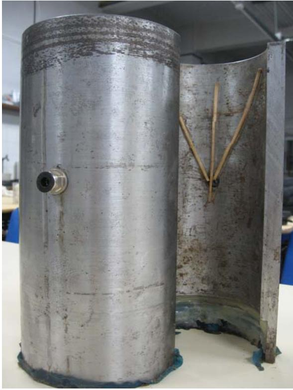
Figura 2.17: Molde metálico para armado de muestra.
