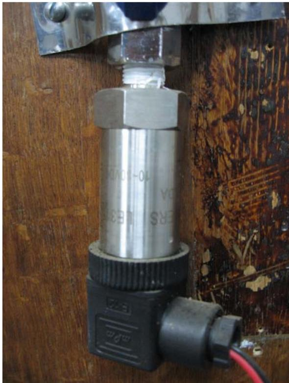
Figura 2.7: Transductor absoluto de presión.
