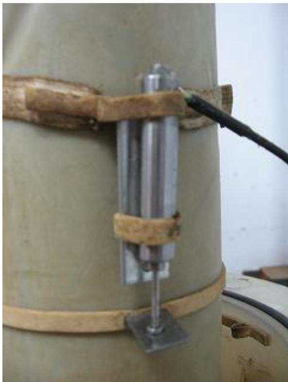
Figura 2.14: Montaje del LVDT.
