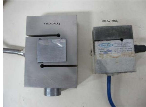
Figura 2.4: Celdas de carga utilizadas.
