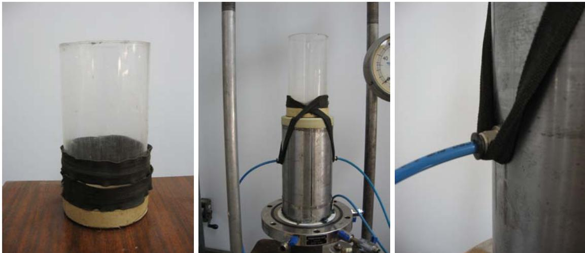
Figura 2.1: Detalle y colocación del cilindro de acrílico.
