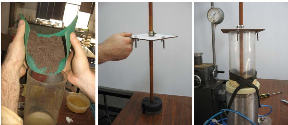
Figura 2.2: Armado de muestra mediante *Moist Tamping*.
