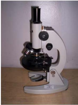
Figura 4.2: Microscopio Arcano L101 (400x).
