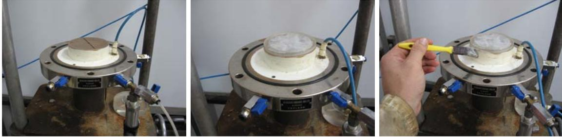
Figura 1.1: Colocación piedra porosa inferior, fijación con cinta y envaselinado de la base.
