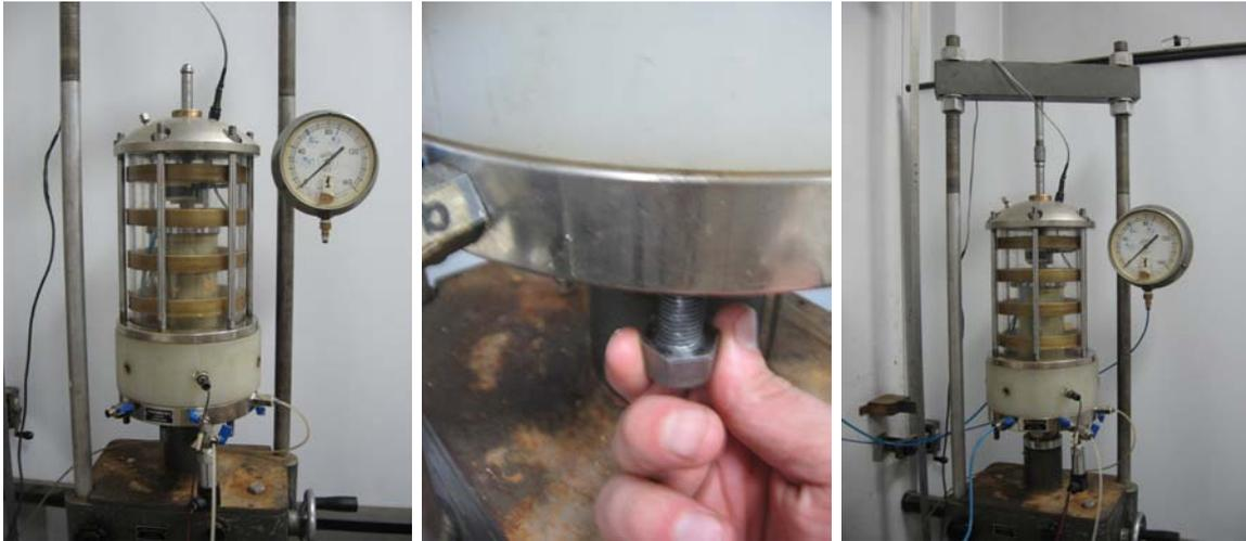
Figura 2.8: Colocación y ajuste de cámara.
