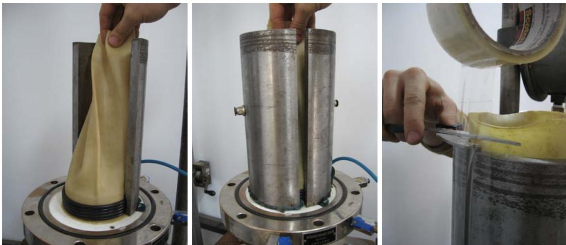
Figura 1.3: Colocación y sellado del molde.
