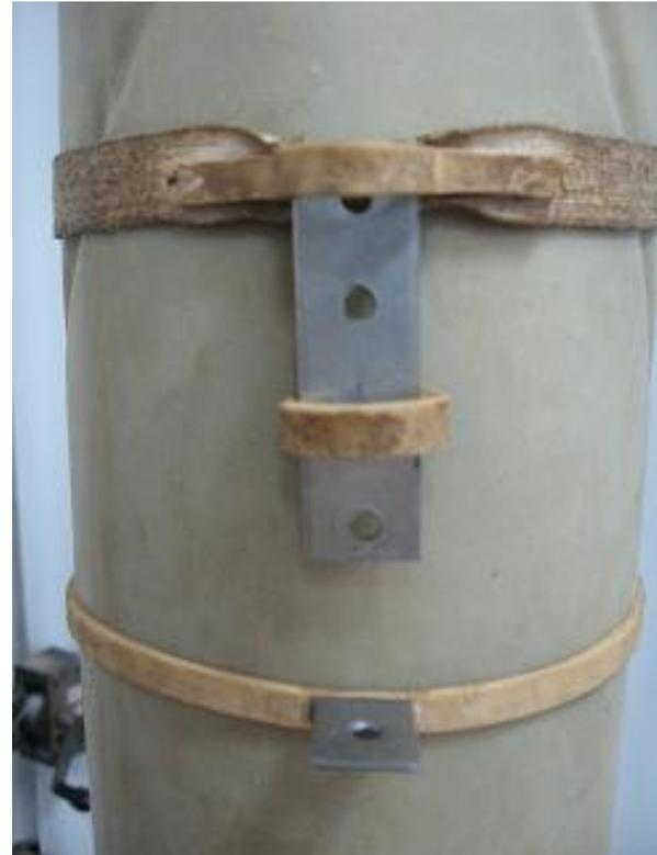
Figura 2.13: Elementos de montaje de los LVDT.
