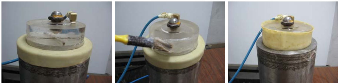
Figura 2.4: Colocación y envaselinado de cabezal superior.
