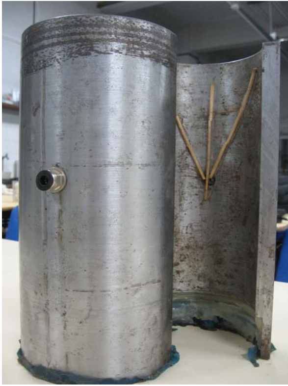
Figura 2.17: Molde metálico para armado de muestra.
