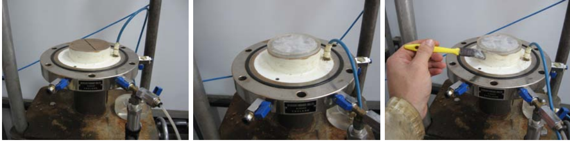
Figura 1.1: Colocación piedra porosa inferior, fijación con cinta y envasinado de la base.
