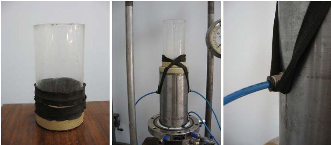
Figura 2.1: Detalle y colocación del cilindro de acrílico.
