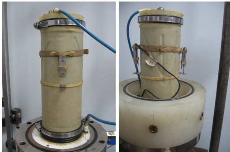
Figura 2.7: Montaje de soporte de LVDTs y anillo blanco. Colocación de LVDTs.
