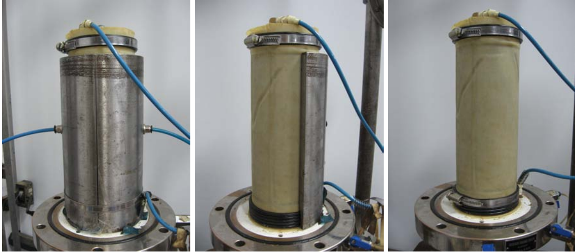
Figura 2.6: Desmonte de molde metálico.
