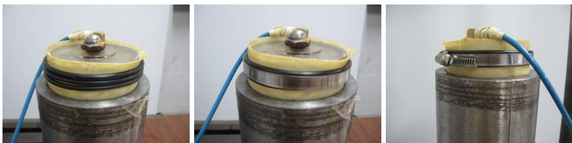
Figura 2.5: Colocación de O-rings y abrazadera en cabezal superior.
