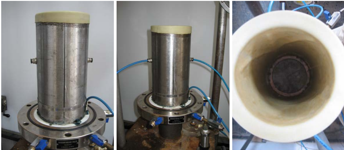
Figura 1.4: Fijación y aplicación de vacío entre la membrana y el molde.
