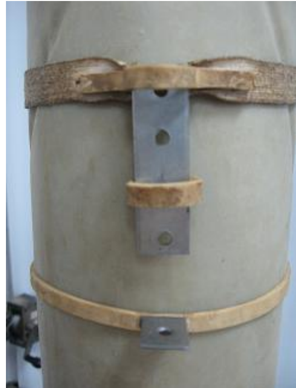
Figura 2.13: Elementos de montaje de los LVDT.
