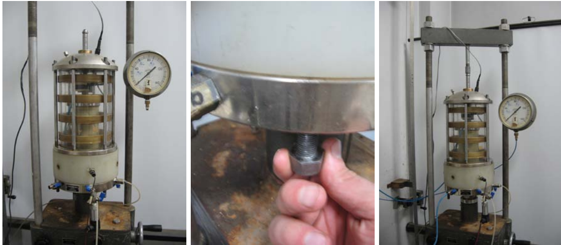
Figura 2.8: Colocación y ajuste de cámara.
