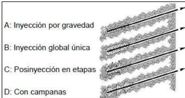
Figura 5-3. Técnicas de inyección de anclajes (FHWA 1999).
