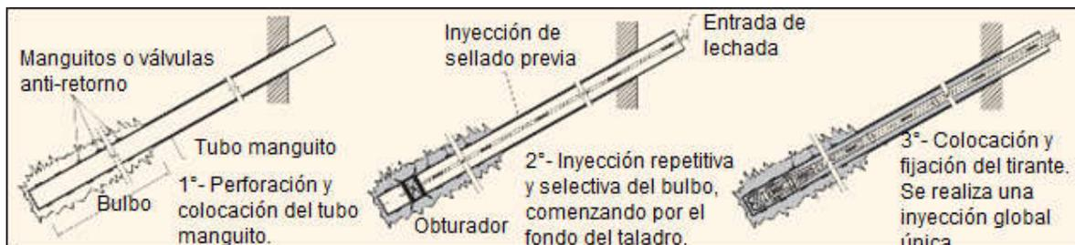
**Figura 5-8. Procedimiento de inyección repetitiva y selectiva (DGC 2001).**
