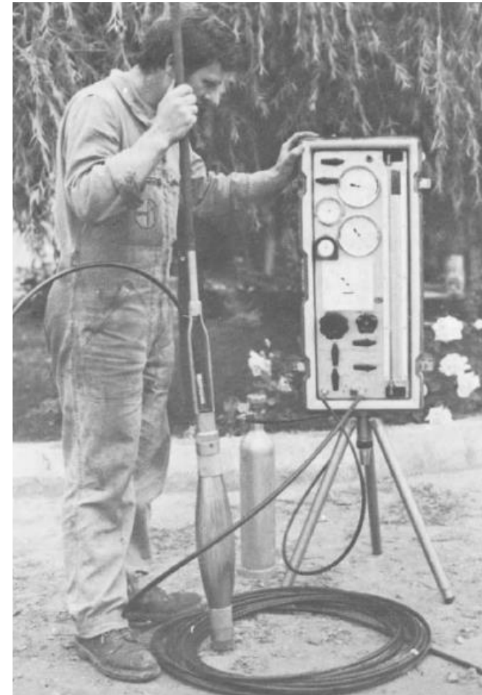
Sonda + tablero control + presurizador
