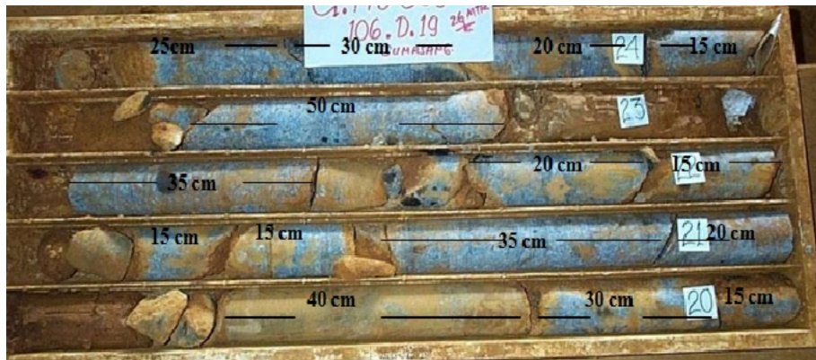
Figura 5.1: Testigos de roca extraídos.
