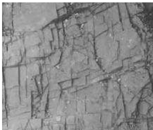
Figura 5.3: Fotografía de las discontinuidades de la roca de sitio.
