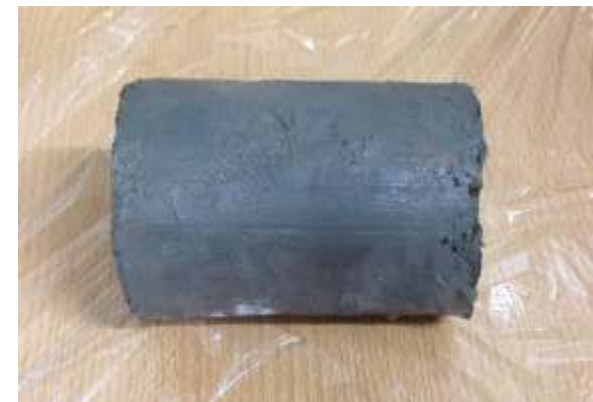
Muestra de arcilla plástica (CH) del Postpampeano extraída con sacatestigo de reducida alteración
