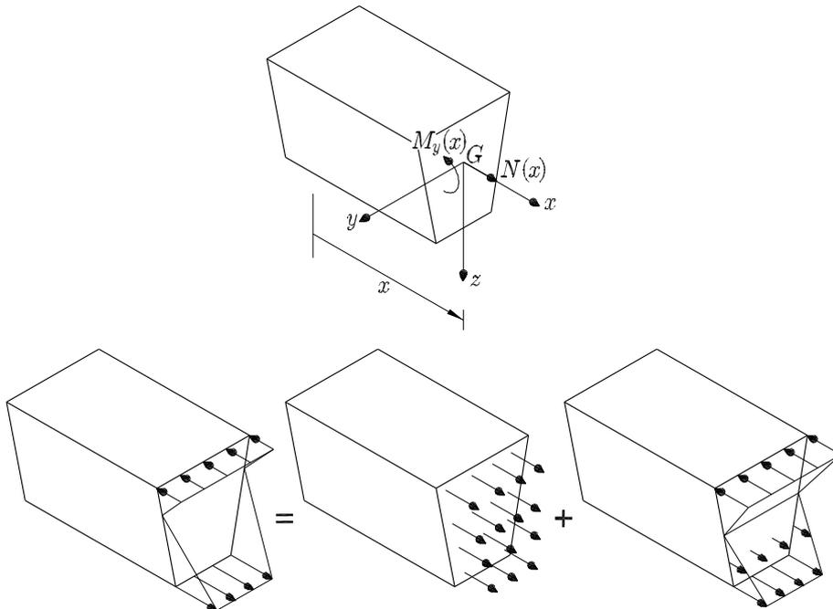
**Figura 11.1** Distribución de tensiones en una sección sometida a flexión compuesta según el eje  $y$
