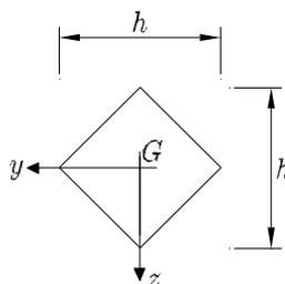
**Figura 11.9** Sección romboidal
