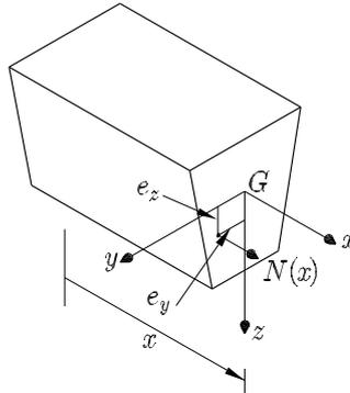
**Figura 11.4** Axil actuando excéntricamente sobre una sección
