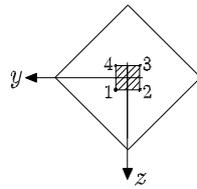
**Figura 11.10** Sección romboidal. Núcleo central
