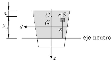
Figura 11.6 Secciones sin zona de tracción
