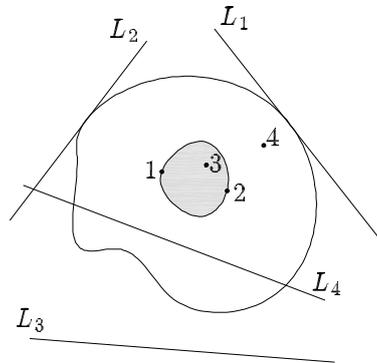
**Figura 11.3** Concepto de núcleo central
