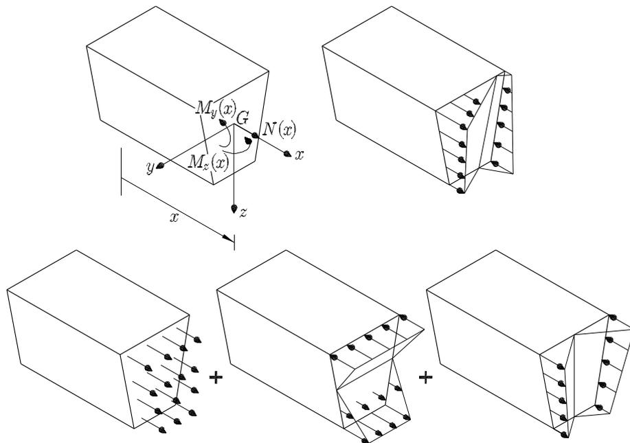
**Figura 11.2** Distribución de tensiones en una sección sometida a una sollicitación de flexión compuesta desviada
