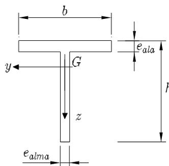
**Figura 11.7** Sección en T sometida a flexión compuesta desviada
