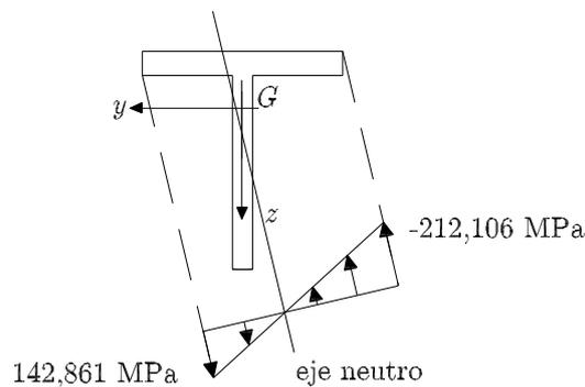
**Figura 11.8** Sección en T sometida a flexión compuesta desviada. Distribución de tensiones normales
