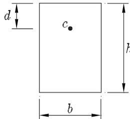
**Figura 11.11** Sección rectangular sometida a un axil de compresión excéntrico
