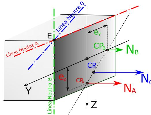
Fig. 1.6: Núcleo Central - Relación entre líneas neutras y centros de presión
