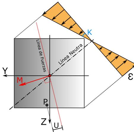
Fig. 1.3: Diagrama de tensiones
