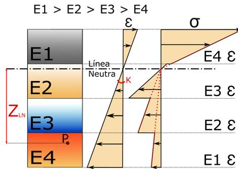
Fig. 1.9: Diagramas de deformaciones y tensiones - Sección heterogénea
