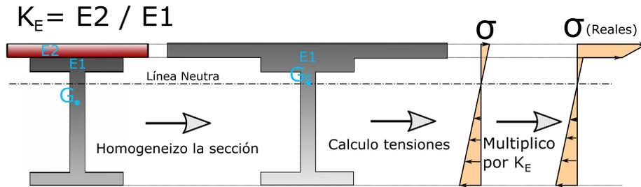
Fig. 1.10: Diagramas de Tensiones Finales
