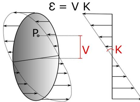
Fig. 1.1: Deformación generada por la flexión
