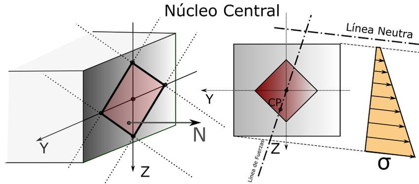
Fig. 1.7: Núcleo Central - Región geométrica
