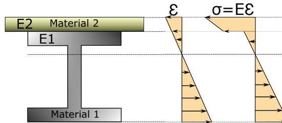
Fig. 1.8: Diagramas de Deformación - Material Compuesto
