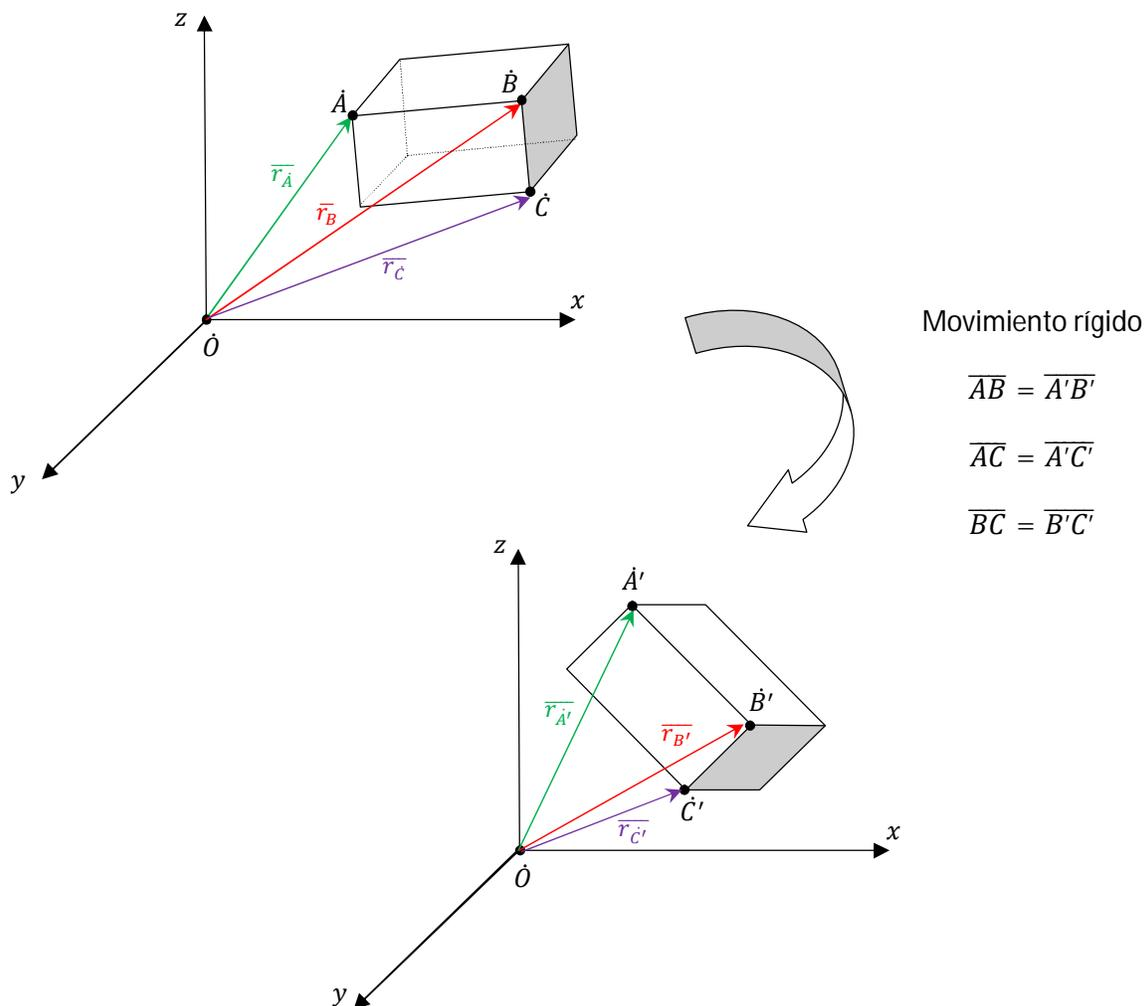
Luego del movimiento rígido, los puntos  $A$ ,  $B$  y  $C$  pasan a ocupar (para el mismo sistema de referencia), las posiciones  $A'$ ,  $B'$ ,  $C'$ . Pero la distancia entre cualquier par de puntos
