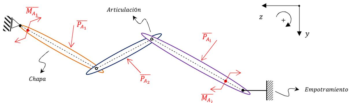
**Aclaración:** El sistema de la figura corresponde a una cadena cinemática abierta de chapas articuladas en el plano, sustentada por un empotramiento y un vínculo de 2da especie aplicados en los extremos de la cadena. Las características particulares de cada elemento de la figura y el estudio del sistema se verán a continuación.
