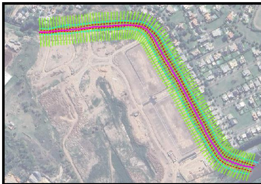
Ilustración 27- Secciones transversales autogeneradas
