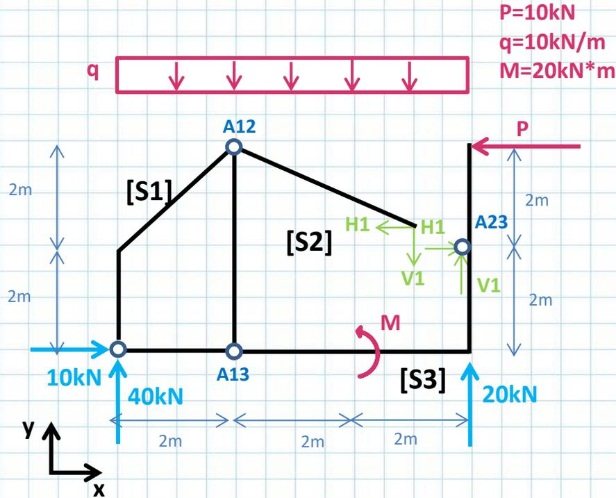
$$\Sigma M_{A12.S2} = -q \cdot 4 \text{ m} \cdot 2 \text{ m} - V_1 \cdot 4 \text{ m} - H_1 \cdot 2 \text{ m}$$
