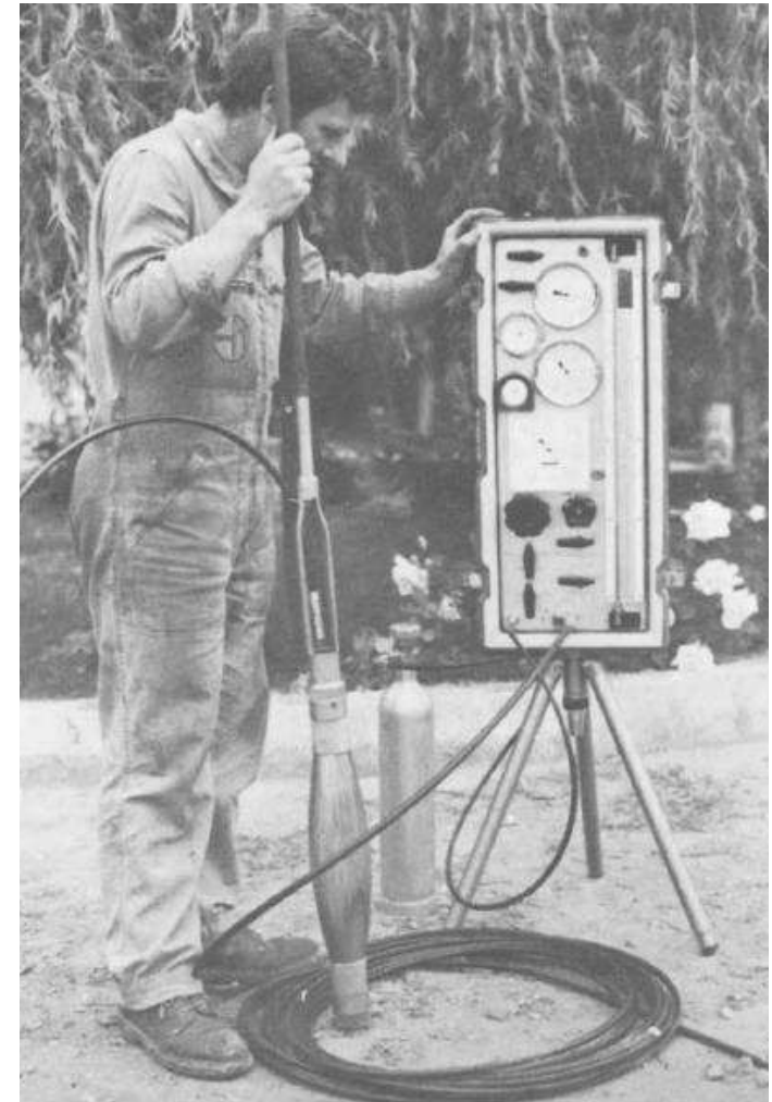
Sonda + tablero control + presurizador
