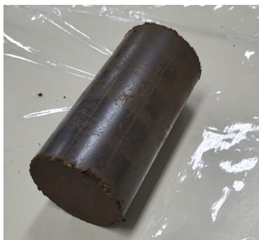
Figura 3. Muestra terminada. Compactación estática por capas.
