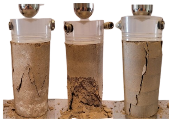
Figura 6. Patrones de rotura en probetas con 7 días de curado y 24 hs de secado post curado (7d - S 24h).
