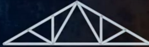
Fan roof truss
