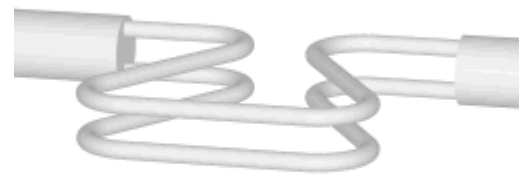
Arcos vibrando sin circulación de fluido (~ 1000 vibraciones/segundo, de pequeña amplitud)
