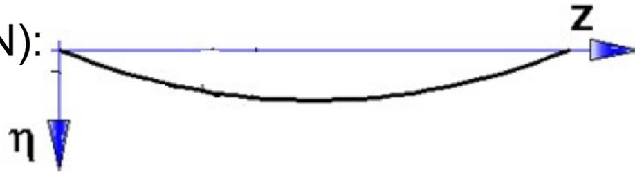
Elástica de deformación para barra simplemente apoyada
