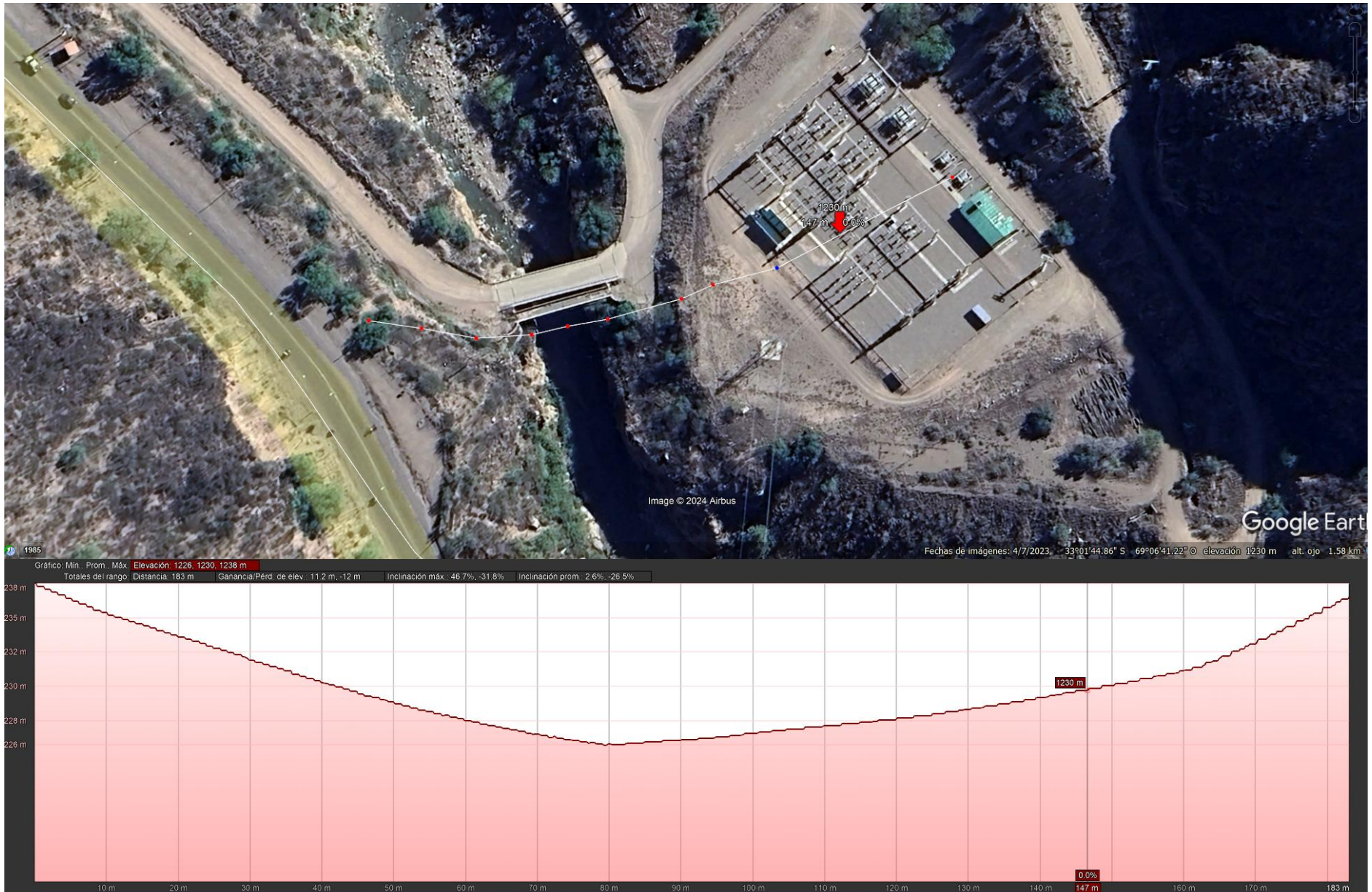
Sección transversal del Río – Ubicación PUENTE 1
