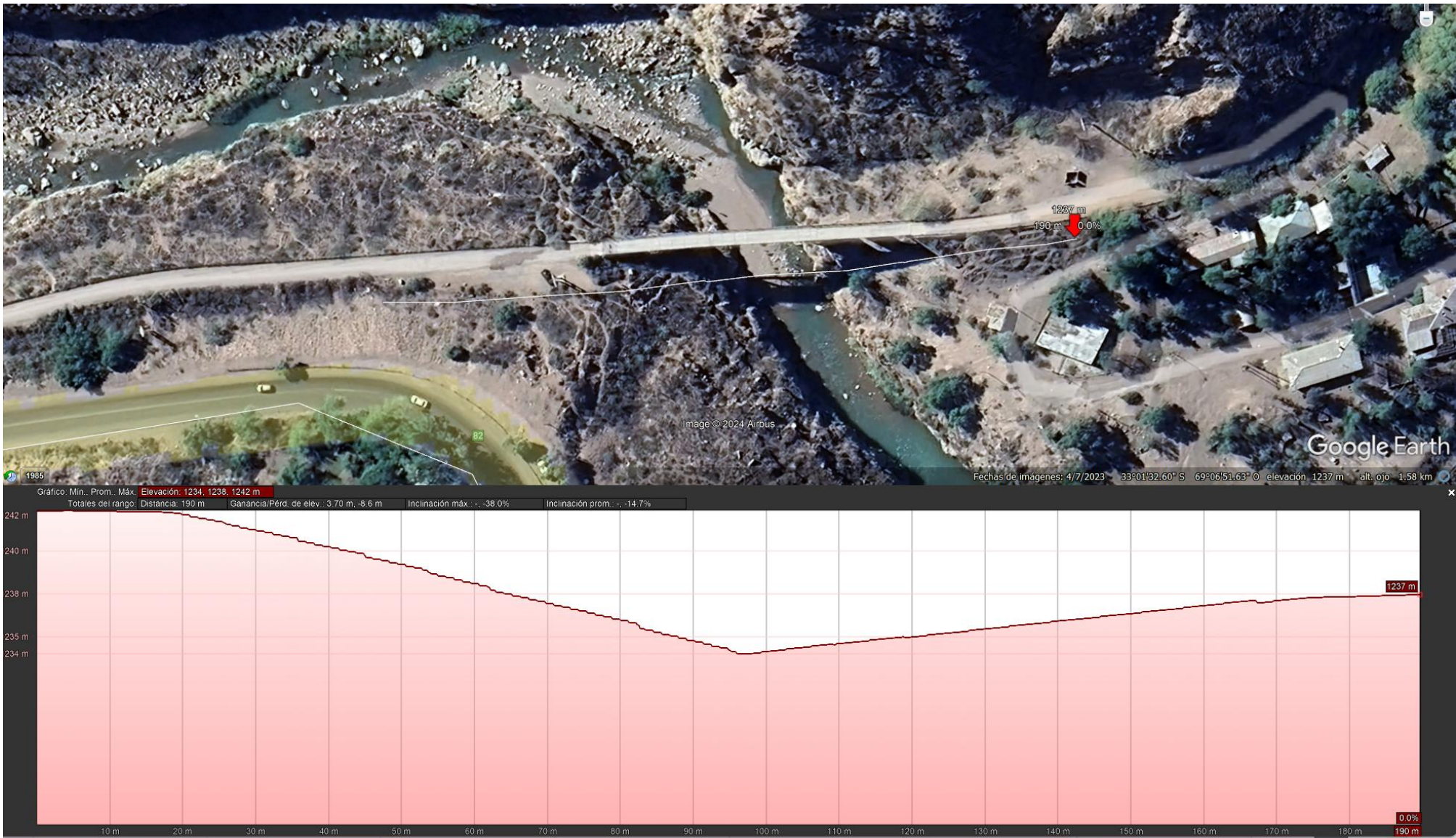
Sección transversal del Río – Ubicación PUENTE 3
